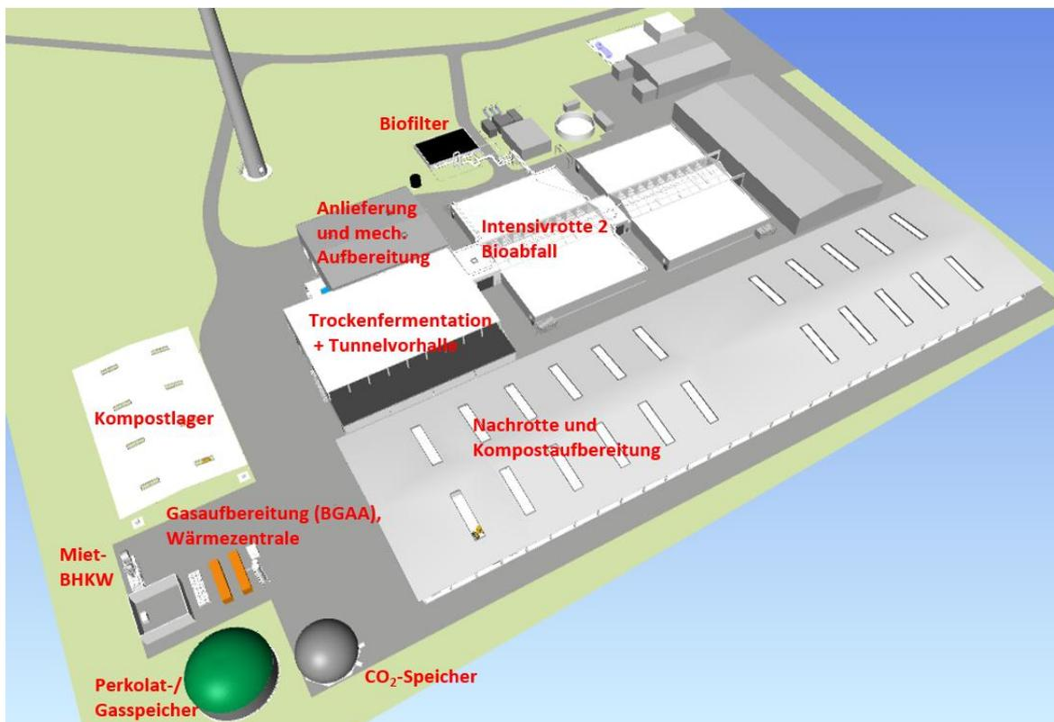
Abbildung 41: 3-D Ansicht der geplanten erweiterten Kompostierungsanlage der MBA Schwanebeck mit einer Vergärungsstufe (Planungsstand Juli 2024)
