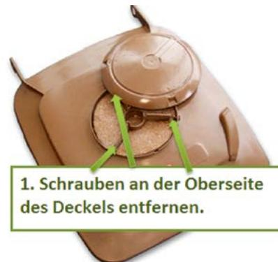
Bei beiden Behältergrößen entnehmen Sie bitte die Kappe vom Deckel. Entfernen Sie das alte Biofiltermaterial und entsorgen es in der Biotonne. Legen Sie nun die neuen Presselinge/Filter in die Kammern und befeuchten diese mit 500 ml warmem Wasser. Danach legen Sie die Kappe wieder auf, bis Sie hörbar einrastet. Bei der 240 l Tonne ist noch eine Befestigung der Schrauben erforderlich.
